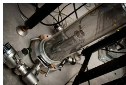
Gravimetro portatile sviluppato in INRiM.
