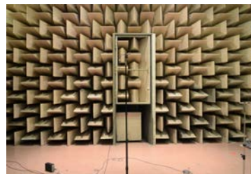
Camera semi-anechoica attualmente in funzione presso i laboratori di Acustica dell'INRIM.
