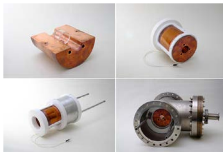
Camera progettata e realizzata all'INRiM per termostatare una cella in quarzo contenente atomi di mercurio per spettroscopia Doppler (DBT).
